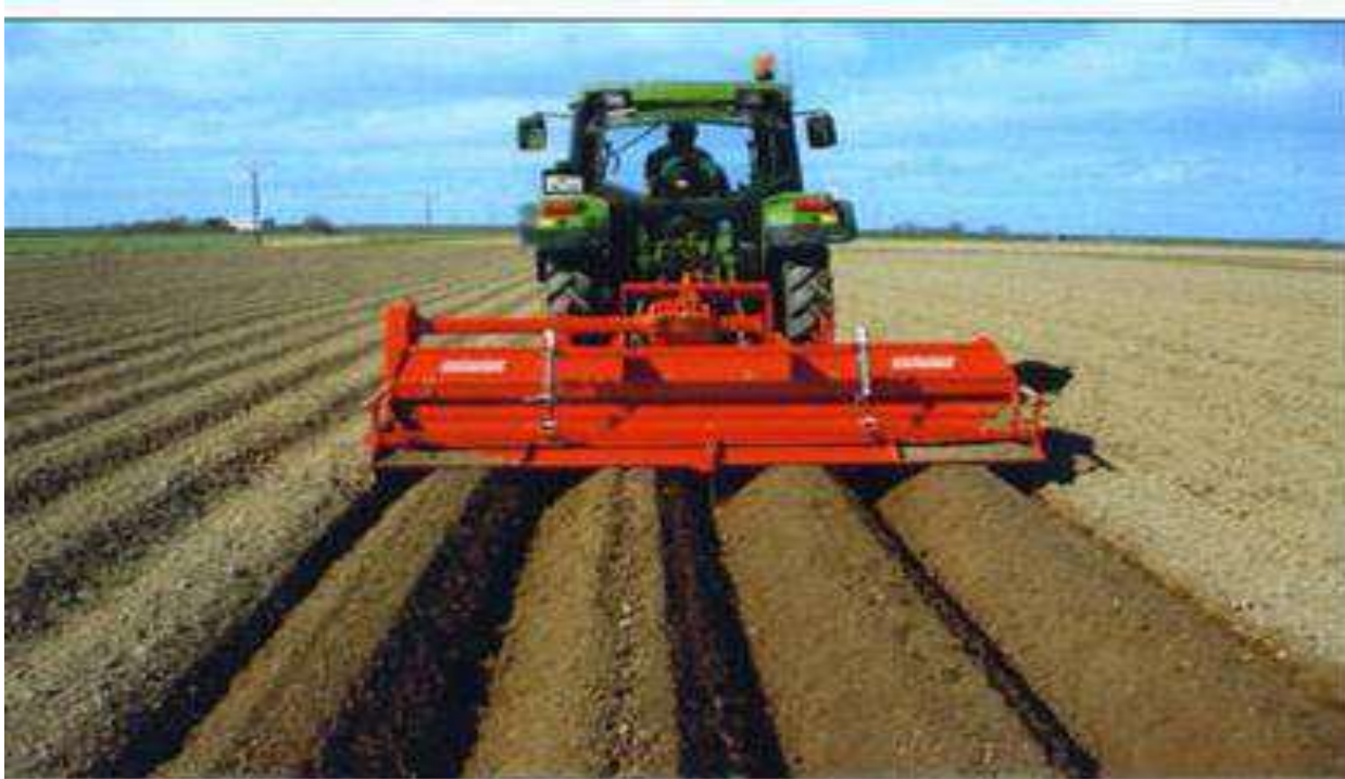
Гребнеобразующая фреза – RF-4
