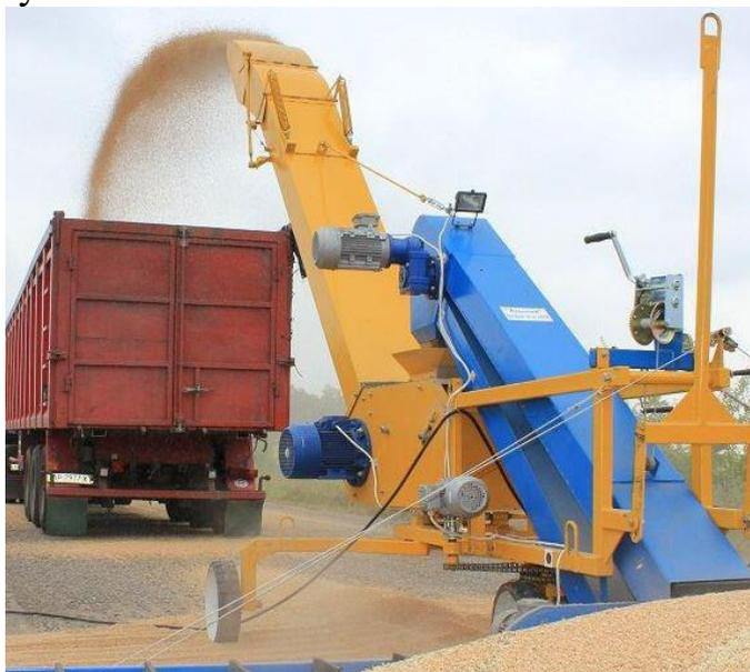
Рисунок 5 – Зернометатель - недопустимая техника для перекидывания сои
