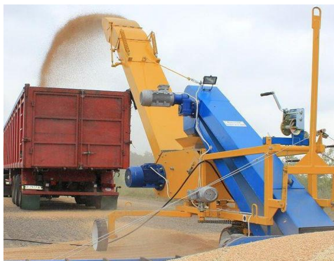
5 сурет - Астық шашыратқыш – бұршақты лақтыруға сәйкес келмейтін техника
