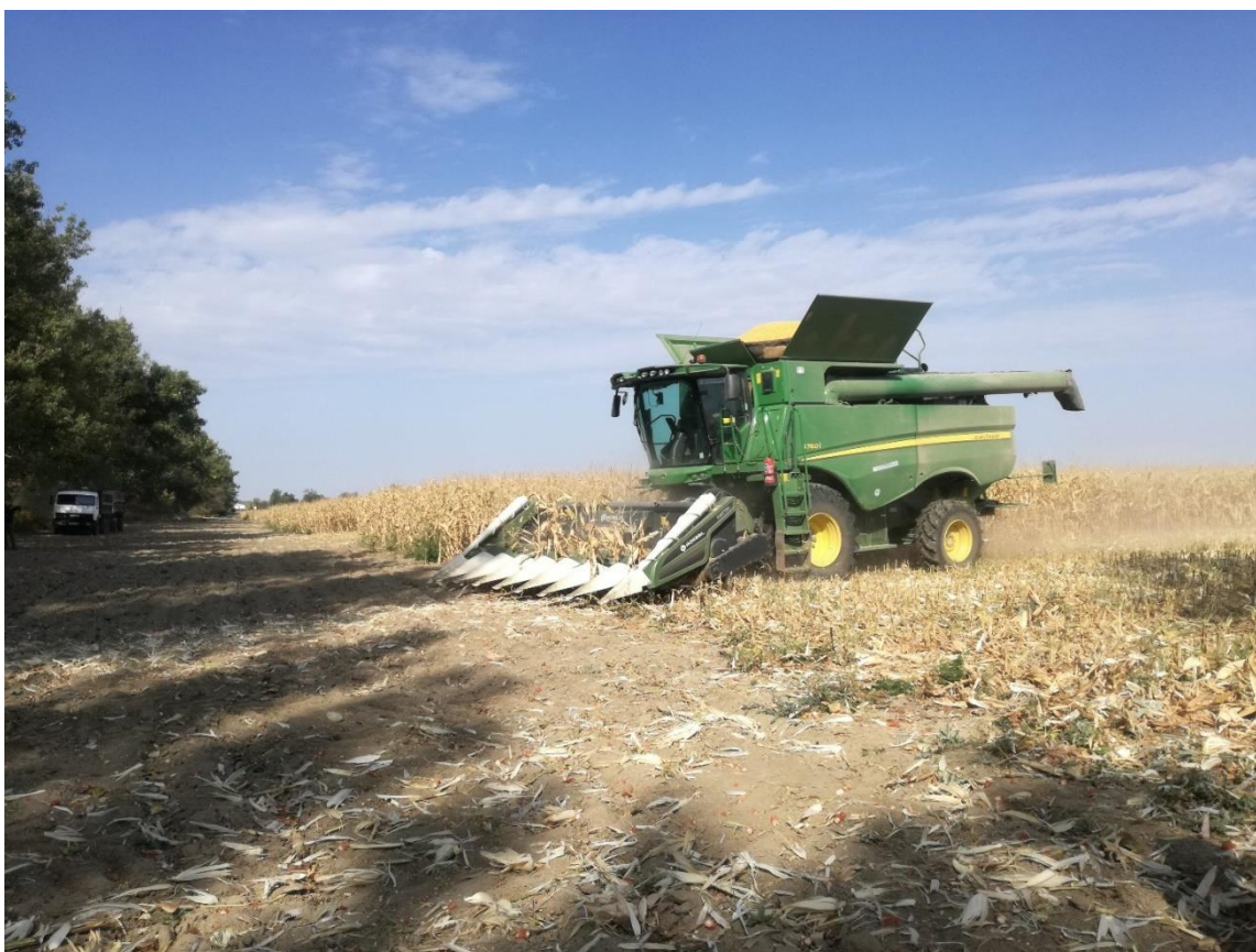
Рисунок 3 – Уборка кукурузы на зерно зерноуборочным комбайном John Deere S770
