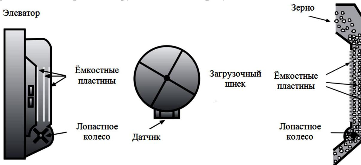
Рисунок 7 – Расположение датчика влажности зерна
