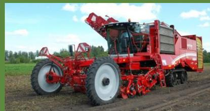
Картофелеуборочные комбайны эффективно работают при твердости почвы 1,4 ПМ, засоренности камнями (диаметром до 150 мм) в пахотном слое - до 8т/га, урожайности - от 150 до 500 ц/га, глубине залегания нижних клубней - до 22 см; влажности почвы не более 23%.
