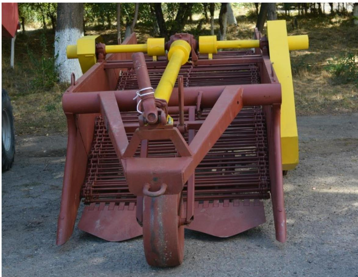
Рисунок 4-Картофелекопатель КСТ- 1,4
