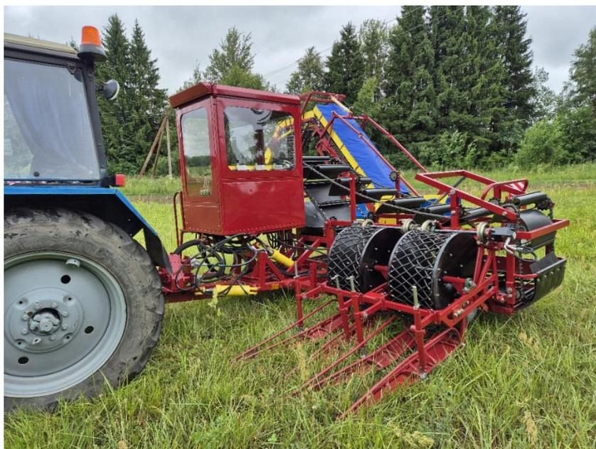
Рисунок 5 - Малогабаритный капустоуборочный комбайн МКК-2
