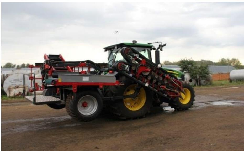
Рисунок 8 - Капустоуборочный комбайн Vanhoucke
