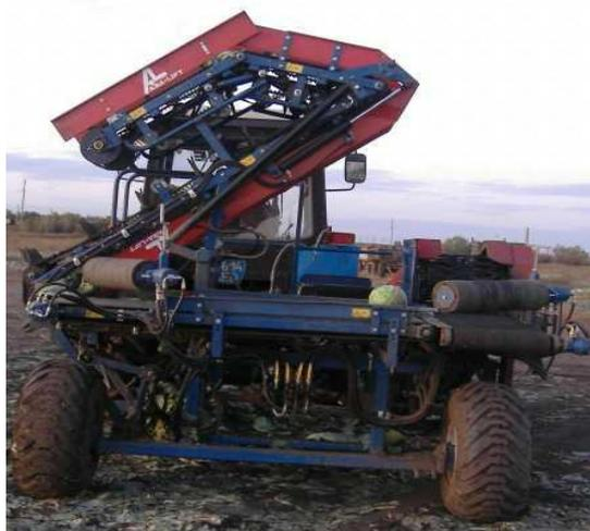
Рисунок 9 - Транспортное положение капустоуборочной машины МК-1000
