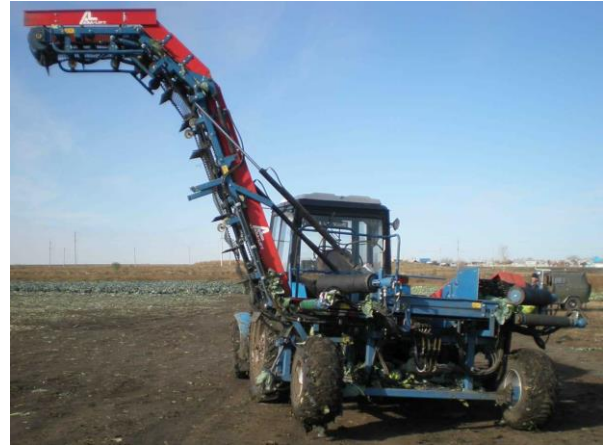
10-сурет – МК-1000 қырыққабат жинайтын машинаның жұмыс жағдайы
