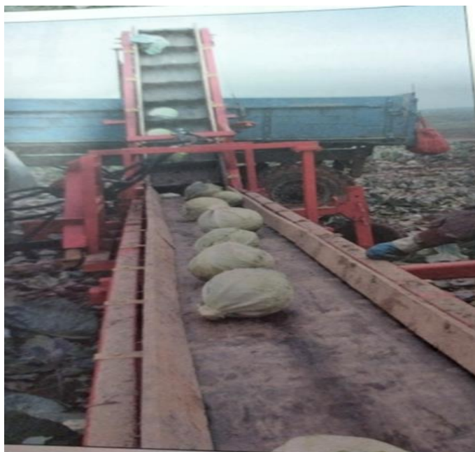
2 - сурет-қырыққабат Жинау платформасы
