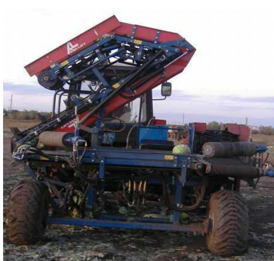
9-сурет – МК-1000 қырыққабат жинайтын машинаның көліктік жағдайы
