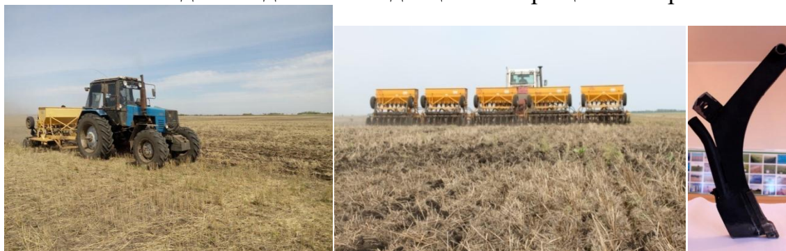
Посев сеялками СЗД-2,1, оборудованными анкерными сошниками
